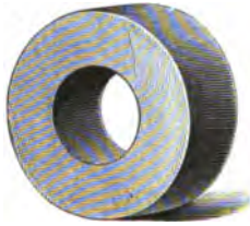
Rahmen von Holz als Unterlage zum Herausdrücken der Scheiben von festem Kohlendioxyd.
